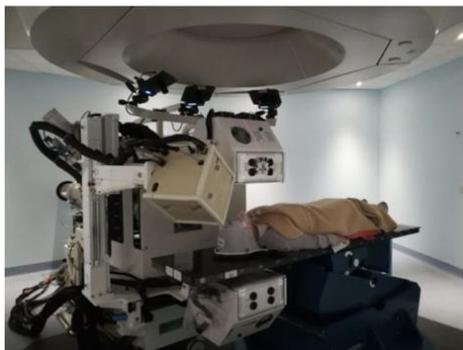
Figura 3.4: Fotografia della sala di trattamento del CNAO con il sistema INSIDE integrato. Il box beige è il DP mentre i box bianchi sopra e sotto il letto del paziente sono le teste PET [39].
