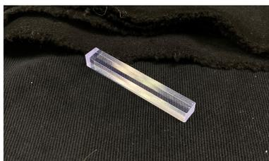
Figura 4.16: Foto di una stecca scintillante come quelle utilizzate all'interno del calorimetro.
