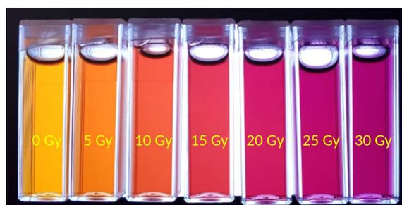
**Figura 1.6:** *Dosimetro a gel di Fricke con XO irradiato a diversi valori di dose [17].*
